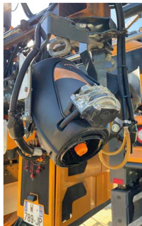
Le modèle E-Sprayer de Pellenc dispose d'une buse centrifuge.
