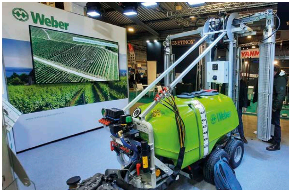
Prototype de turbine tangentielle à alimentation électrique Weber.
